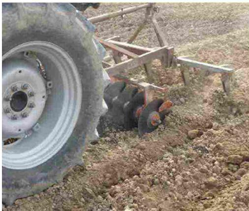
**Foto 1** Operatrice utilizzata per l'interramento superficiale del compost entro i 15 cm di profondità
