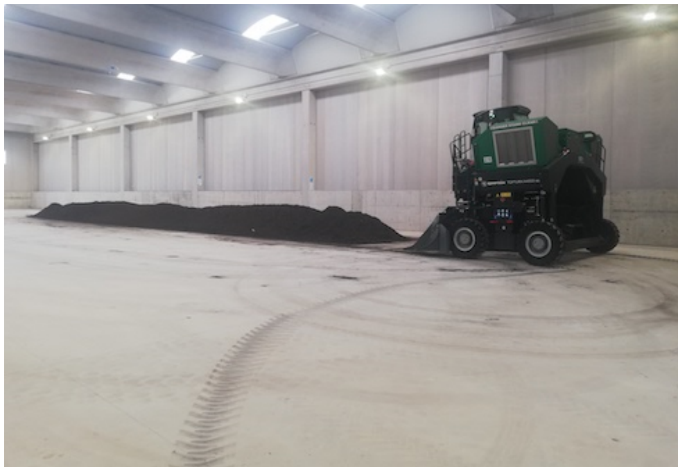
Macchina utilizzata per il ribaltamento periodico della matrice organica
